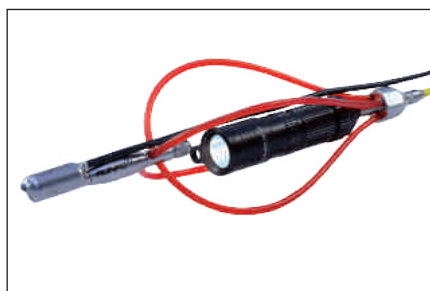
RUNPOCAM – base giratoria – deslizador funcional (dentro va la lámpara LED recargable) – cable de alimentación con rosca RUNPOTEC RTG de Ø 6 mm. Para tuberías anchas.
