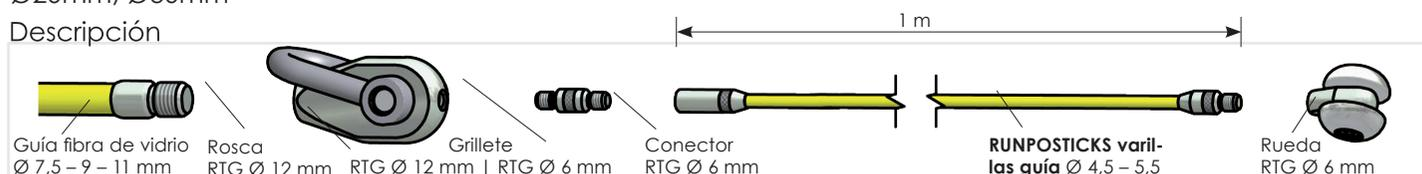
Las varillas guía RUNPOSTICKS tienen distintas flexibilidades, se pueden extender a razón de 1 metro por cada varilla y acoplar en la punta una más varilla flexible Ø 7.5 / Ø 9 y Ø 11 mm para superar curvas estrechas. Además es posible, enroscar accesorios como la rueda, la punta flexible RUNPOGLIDER con la misma finalidad.
