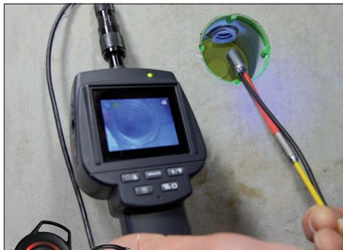
**INSPECCIÓN DE TUBERÍAS** Ø desde 20 mm
