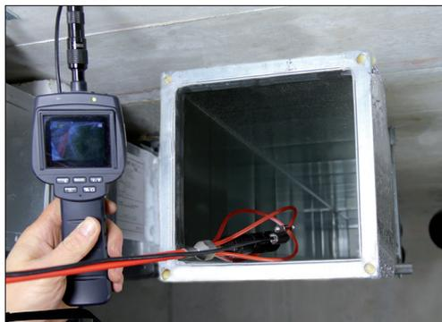
**INSPECCIÓN DE CIRCUITOS DE VENTILACIÓN**
