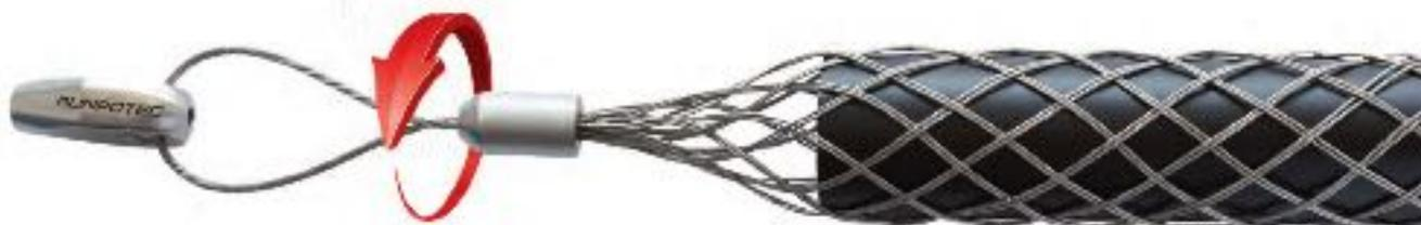
Malla tiracables con rosca RUNPOTEC RTG de Ø 12 mm y de Ø 6 mm, incluye base giratoria, hecha de acero inoxidable de alta calidad. **Ventajas de la base giratoria:** Compensa la torsión del cable dentro del tubo, se fija rápida y fácilmente, evita el enroscado del cable. La alta calidad de sus materiales prolonga su vida útil. Se puede acoplar a rosca RUNPOTEC RTG de Ø 12 mm y de Ø 6 mm.
