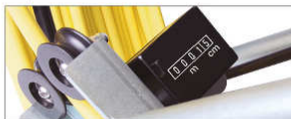
El contador mide en metros y centímetros
