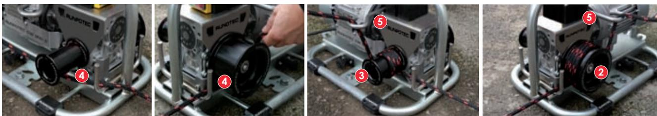
La cuerda de remolque se mete dentro del pasador de cable (4) y se enrolla al menos 3 veces alrededor del rodillo de tracción (2 o 3). Luego se mete por el aro del cable (5). Mantenga la cuerda de remolque tirante, para que no se enrede.
