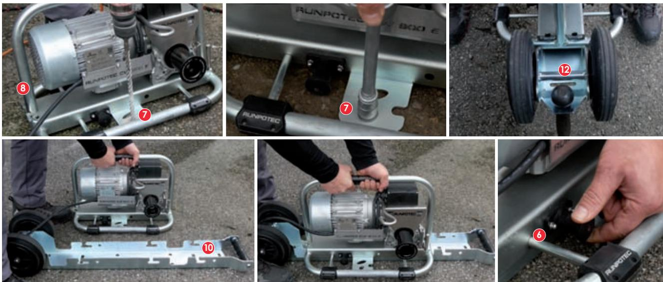
La estructura se puede atornillar al suelo (7), o fijar con una correa y los accesorios adecuados a través del agujero de fijación (8) anclado a un objeto sólido (por ejemplo, un árbol). También se puede fijar la carcasa en el carro riel de RUNPOTEC (10) mediante pernos de bloqueo (6). El propio carro puede atornillarse y colgarse directamente en un enganche de remolque (12) o fijarse con una correa a través del agujero de fijación a un objeto fijo.
