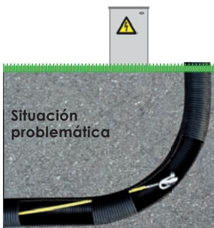
Las guías de fibra de vidrio de Ø 7,5 - 9 o 11 mm se atascan en las curvas con poco radio de giro de las tuberías.
