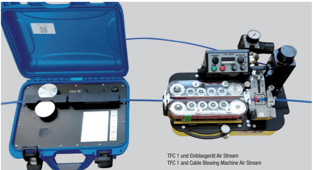
TFC 1 und Einblasgerät Air Stream
