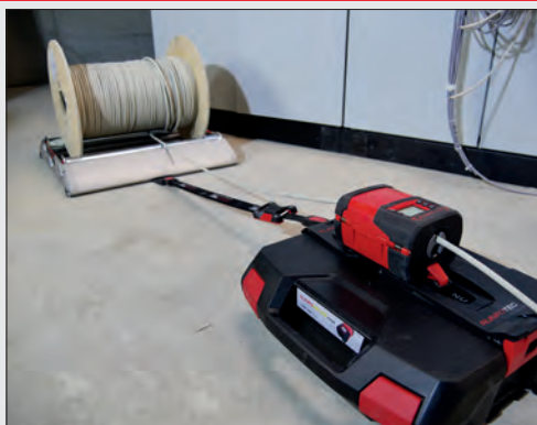
RUNPOMETER RM35 con soporte de anclaje y correa fijada al rodillo de tambor del cable
