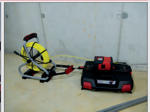
RM35 con soporte de anclaje - maletín y guía pasacables de fibra de vidrio Profi Set Ø 4,5mm
