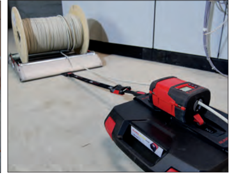
RUNPOMETER RM35 con soporte de anclaje y correa fijada al rodillo de la PRO
